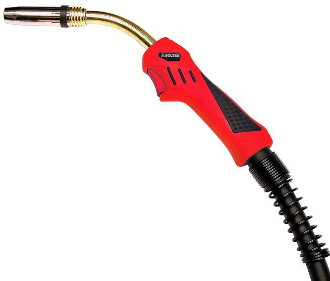
Antorcha MIG/MAG REFRIGERADA POR AGUA con euroconector SX-501. Para soldar con potencias hasta de 500A-60% y con 3m de longitud. Con sirga de poliamida especial ALUMINIO.
