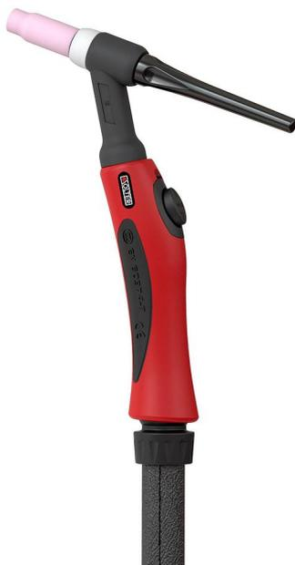
Antorcha TIG SR-18W refrigerada, con conector eléctrico. Para potencias hasta 380A al 100% con 8m de longitud y conector dinse 35-50
