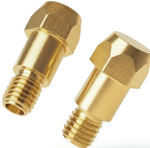
El Portatubo M6 SX-36 de Solter es el componente esencial para soldaduras MIG/MAG de alta precisión. Diseñado para antorchas SX-36, garantiza una **fijación firme de la punta de contacto** y un **flujo de gas constante**, gracias a su fabricación en **cobre de alta calidad**. Con rosca M6 y una longitud de 28,5 mm, permite una instalación sencilla y segura, optimizando cada intervención. Su formato en blíster de 2 unidades lo convierte en una opción práctica para mantenimiento profesional.
