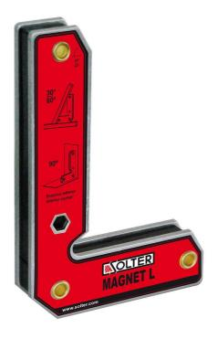
La escuadra magnética MAGNET L de Solter está diseñada para sujetar piezas metálicas con precisión en ángulos de 30°, 45°, 60° y 90°, tanto en aplicaciones internas como externas. Gracias a su imán permanente de alta potencia, proporciona una sujeción firme que mejora la productividad y reduce errores. Sus dimensiones versátiles (165 x 110 x 20 mm) permiten trabajar con estructuras metálicas medianas en procesos MIG, TIG y MMA, siendo ideal para soldadores y montadores profesionales.
